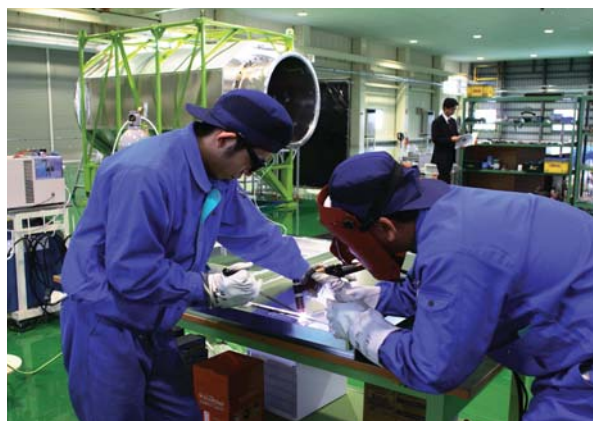
TIG溶接で真空散乱槽(後方)を組み立て
