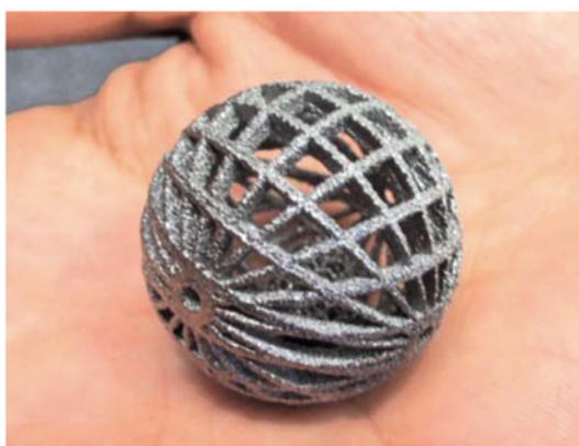
▲.....金属技研が3Dプリンターで作製した内部に球体が入った試作モデル
